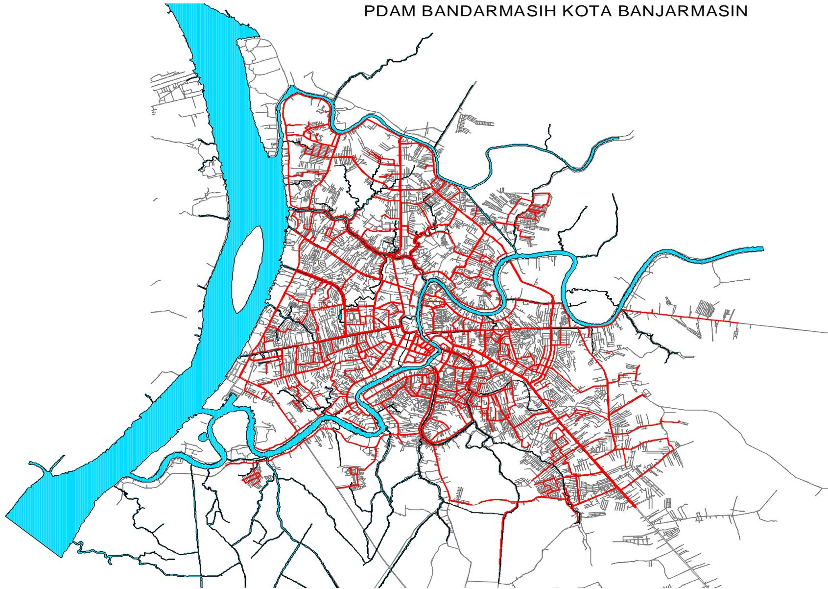
Jaringan pipa transmisi dan distribusi yang ada menggunakan pipa mulai yang berdiameter 50 mm sampai 950 mm dengan panjang keseluruhan 731.588 meter. Sedangkan bahan pipa yang dipergunakan jenis PVC, GIP, DCIP, Steel dan FGRP.
