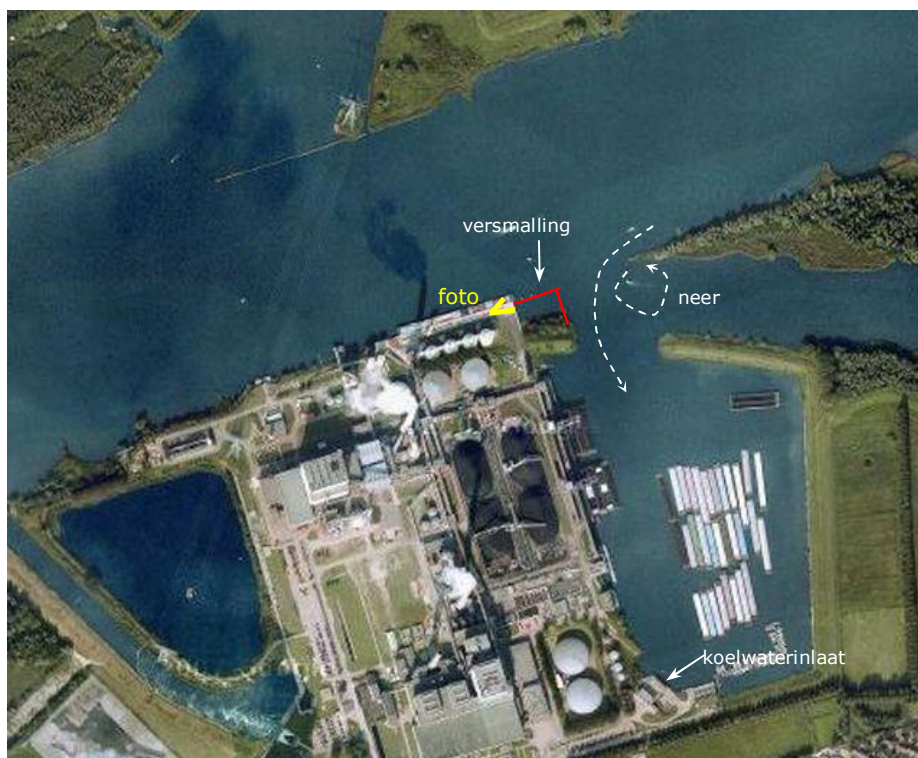
Figuur 4-1 Principe van versmallen haveningang industriehaven Amercentrale
