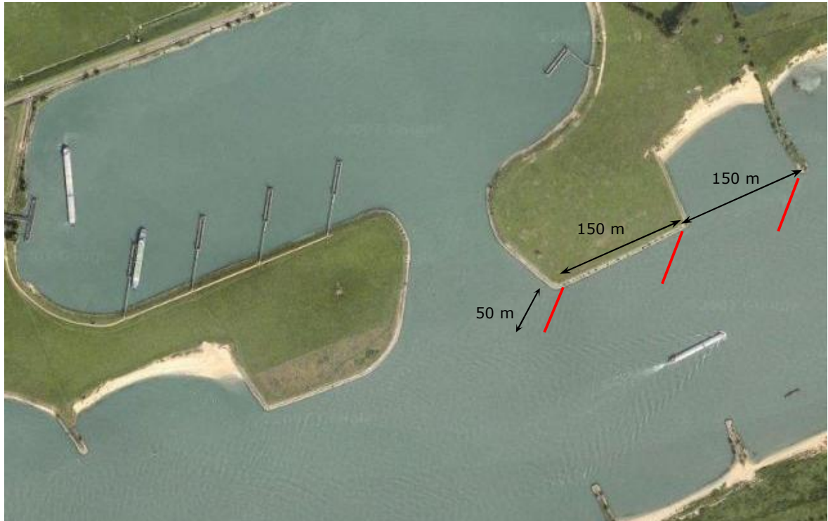
Figuur 6-10 Locatie zandspiraalbuizen bij haven Haaften
