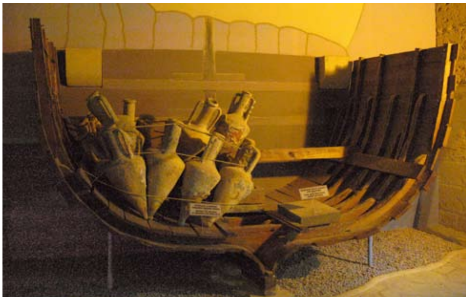
Реконструкция размещения амфор в трюме корабля (фото С. Фазлуллина)
