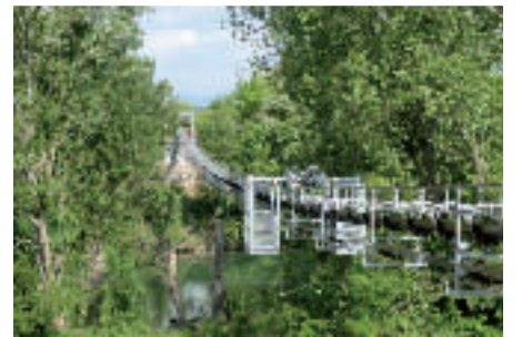
▲ DER FLYING BELT DER SANDGRUBE VON POUZOLS ÜBERQUERT OHNE JEDGLICHEN LÄRM INMITTEN EINER IDYLLISCHEN LANDSCHAFT DEN FLUSS HÉRAULT
