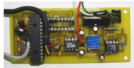
Figura 5 Circuito elettronico di condizionamento del segnale
