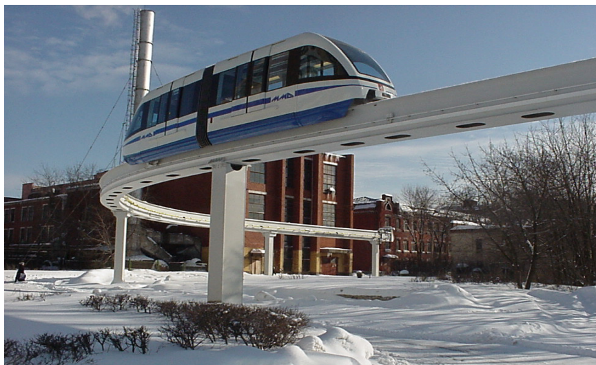
Figur 10: Enkeltspor er estetisk enklere å føre gjennom boligbebyggelse. (Prøvestrekning i Moskva, Intamin)
