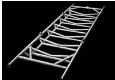
Abb. 5: Tragbahre aus Elektronmetall-Röhren
