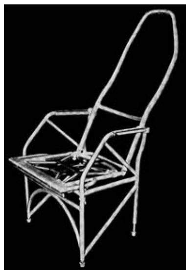
Abb. 6: Verstellbarer Kabinensitz für Verkehrsflugzeuge aus Elektronmetall-Rohren
