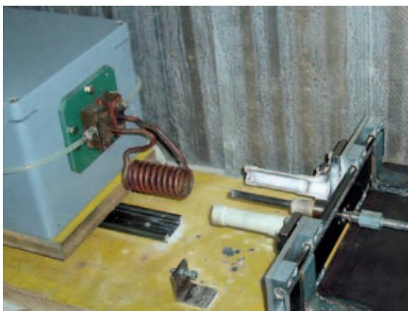
**Abb. 4:** Versuchsaufbau zum induktiven Schäumen in der Keramikform
