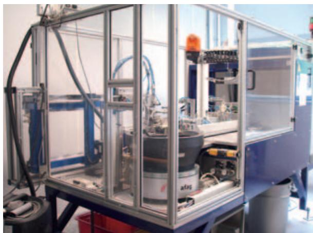
**Abb. 5:** Serienanlage zur Herstellung des Energieabsorbers aus Schaumaluminium
