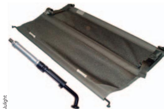
Abb. 1: Trennnetz mit Befestigungssystem samt integriertem Crashabsorber aus Schaumaluminium
