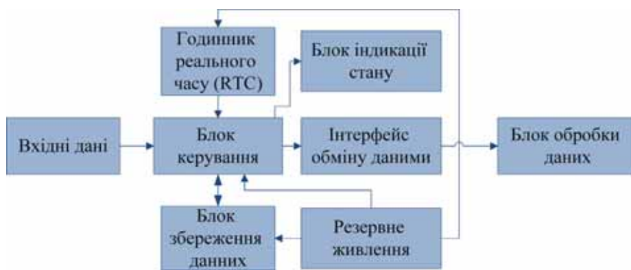
Рис. 1. Структурна схема програмно-апаратного комплексу «Електронний паспорт технічного стану»
