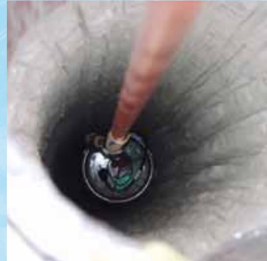
▲ Als Detektoren im arktischen Forschungsprojekt IceCube dienen Digital Optische Module (DOM). Das Bild zeigt die Absenkung eines solchen DOMs in die Tiefen des Eises. (Bild: Mark Krasberg/NSF)
