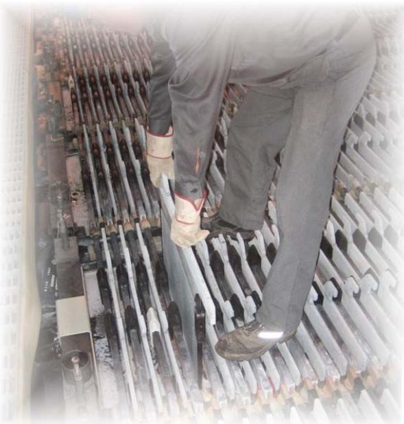
Abbildung 6: Zink-Plattenelektrolyse
