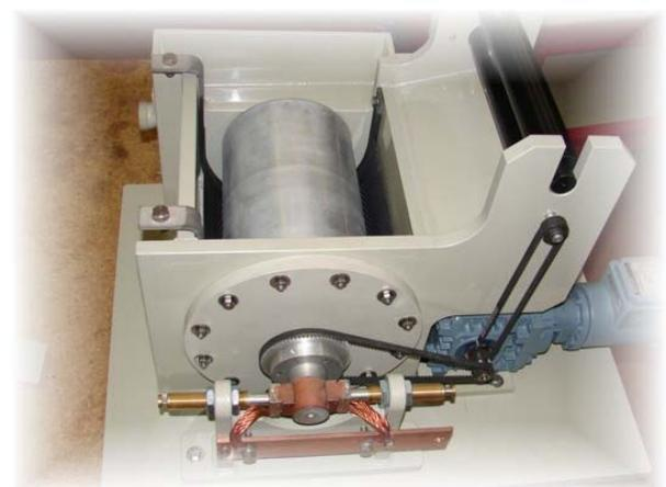
Abbildung 4: kontinuierliches Elektrolysesystem mit rotierender Aluminiumkathode.
