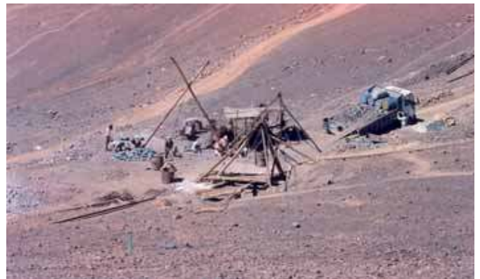
8 Artesanales Bergwerk mit Schacht und LKW-Beladung von Hand Foto: Jürgen Vasters
