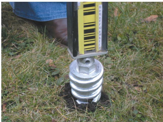
Рис. 4. Пристрій для визначення точки переходу рівня під час роботи
