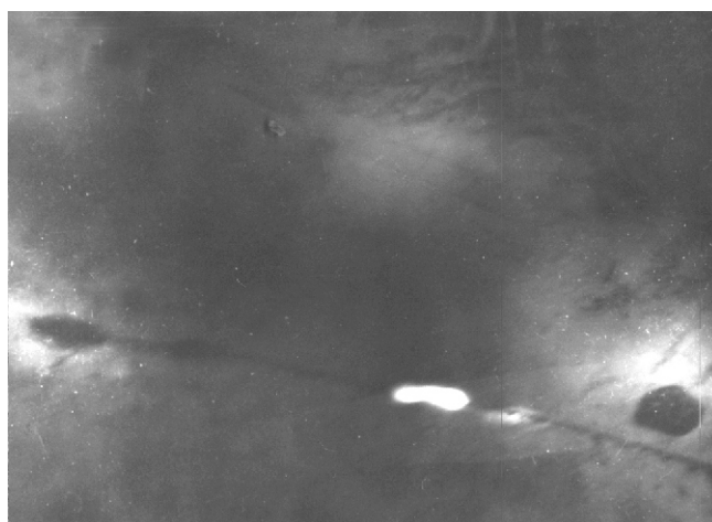
Рис. 7. Микропора на субгранице вблизи карбида Me_{23}C_6 в оболочке змеевика из стали 15X5M, X30000
