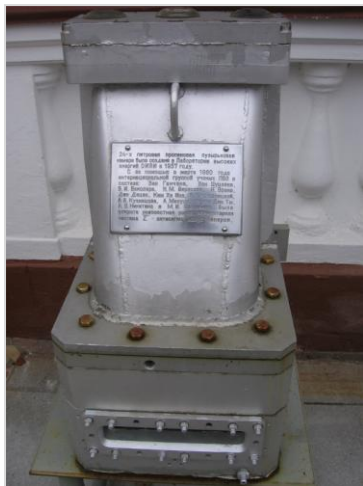
24-литровая пропановая камера, с помощью которой на Синхрофазотроне был открыт антисигма-минус-гиперон
