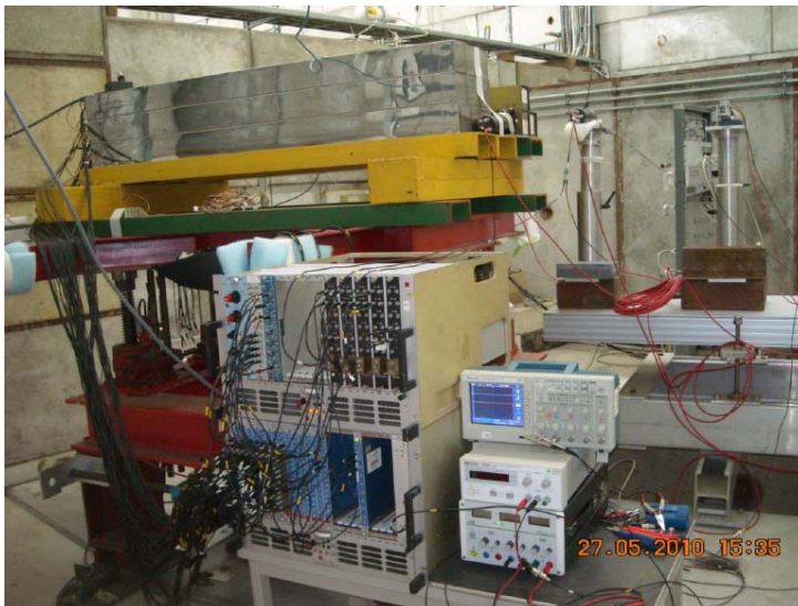
Рис. 2.95: Установка для тестов на пучке с 9-ю прототипами модулей ZDC.
