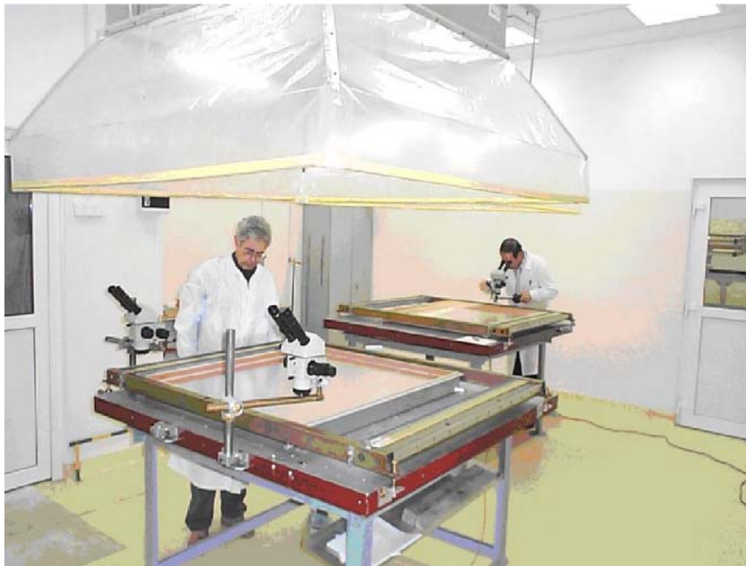
Рис. 2.33: Перенос проволочных плоскостей на рамки камер.
