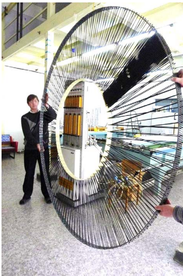
Рис. 2.74: Прототип строу-детектора с 6 слоями трубок.
