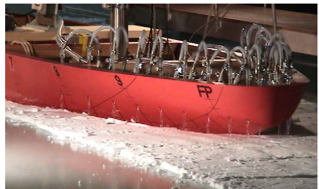
図9 ラミング砕氷試験における散水の状況 Fig.9 Ramming test with water flushing
