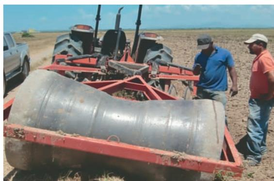
Foto 52. Rolo para adecuar los muros
