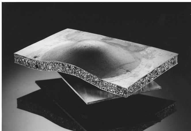
*Fig.23 Panel de sándwich con núcleo de espuma de aluminio y dos hojas superficiales de acero. [13]*
