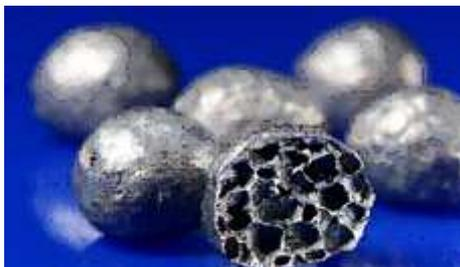
*Fig. 20 Espuma de bolas porosas de aluminio*
