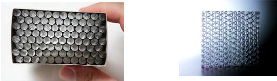
Fig. 17 Paneles de Aluminio y Estructuras panales de abeja-aluminio [9-10]
