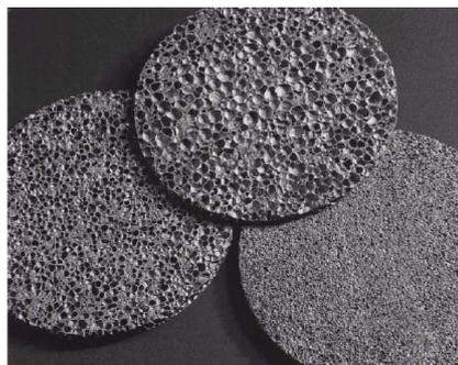
Fig.2. Diferentes estructuras porosas en debidas a diferentes parámetros espumantes (temperatura y tiempo) [1]
