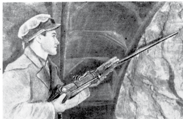
Стахановец-проходчик П. Першаков обуривает забой
