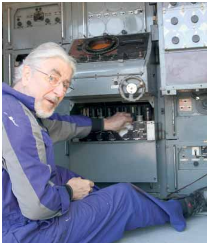
Mittamies- ja tiedustelukilta kunnosti vuoden 1958 mallista lentoratatutkaa. Tutkan kunnostustöissä Markku Saarinen. Kuva: Sirkka Ojala.
