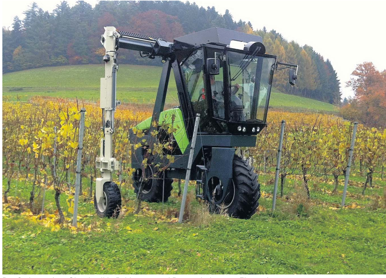
Der Stelzentraktor Ohard soll in Rebbergen und Baumschulen zum Einsatz kommen. ZVG
