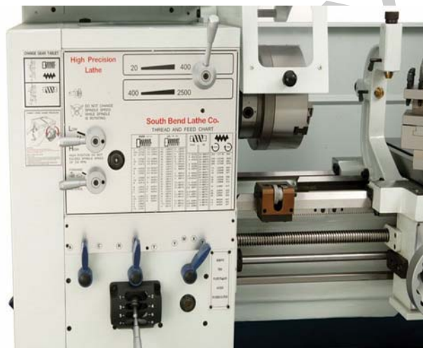
4. ábra. Orsószelekrény(fokozatmentes hajtómű)
