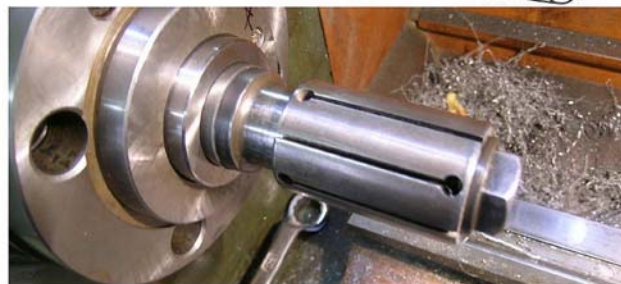
15. ábra. Szorítópatron és alkalmazása
