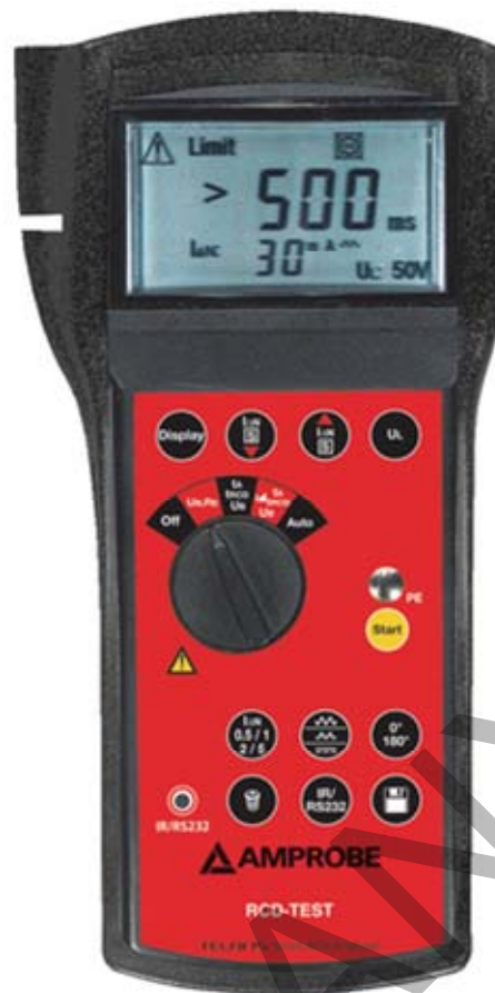
45. ábra. ÁVK ellenőrzésére szolgáló műszer
