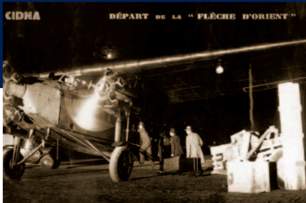
Nächtliche Abreise auf dem Nürnberger Flughafen. Die dreimotorige Wibault 283 der Air France hatte Platz für zehn Passagiere und erreichte eine Reisegeschwindigkeit von 230 km/h.
