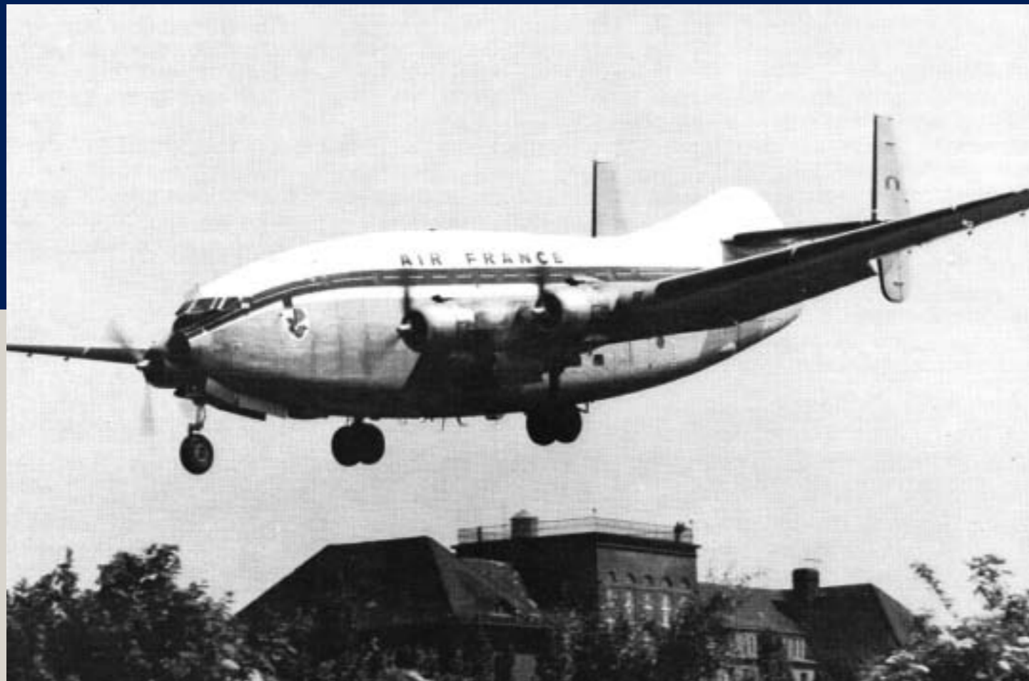
Breguet Deux Ponts ist ein zweistöckiges, viermotoriges Flugzeug, hier im Landeanflug in Berlin. Die auffallend bauchige Maschine verfügt auf der erste Etage über 59 Plätze und darunter 48. Statt Fluggäste kann sie auch mit Fracht beladen werden. (Foto: Fluggesellschaft Berlin)
