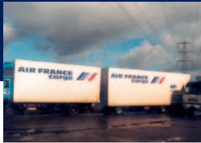
Ein für die Fracht konzipierter Lkw mit versenkbaren Rollenbahnen bringt die Fracht zu den Jumbo- und Combi-Frachtern nach Paris. (Foto: Fünf-Palettenzug der Fa. Haller Stuttgart)
