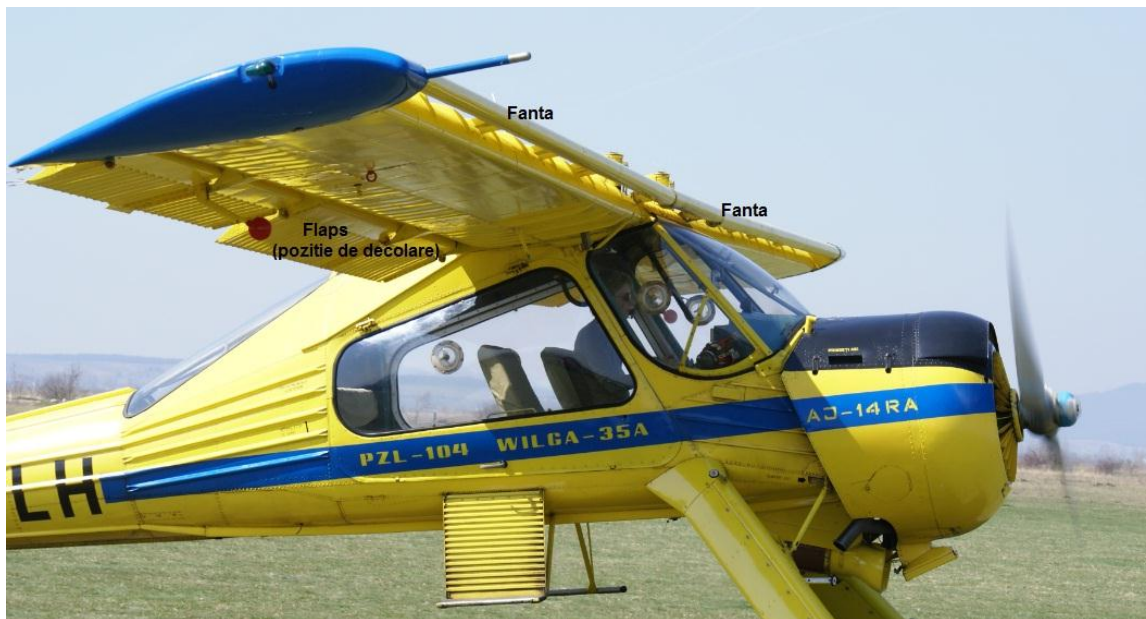
Fig. 1.18 Bracajul flapsului pentru decolare
