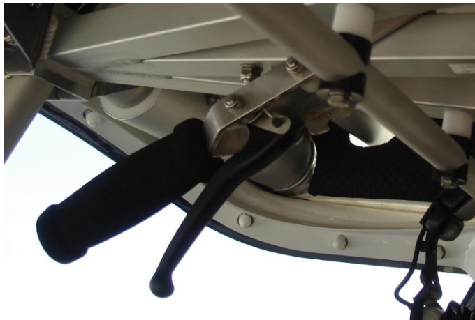
Fig 1.21. Comanda din cabina a flapsului-Ikarus C 42
