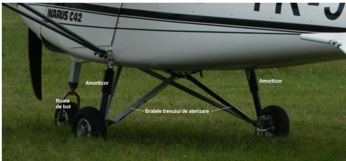
Fig 1.27. Tren de aterizare Ikarus C 42
