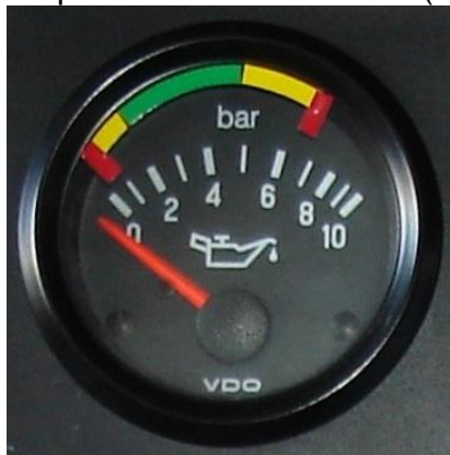
Fig. 2.21. Indicator presiune ulei Rotax 912
