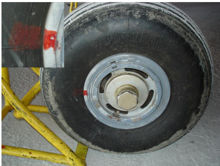
Fig 1.31. Semne pe flansa rotii – Zlin 526F
