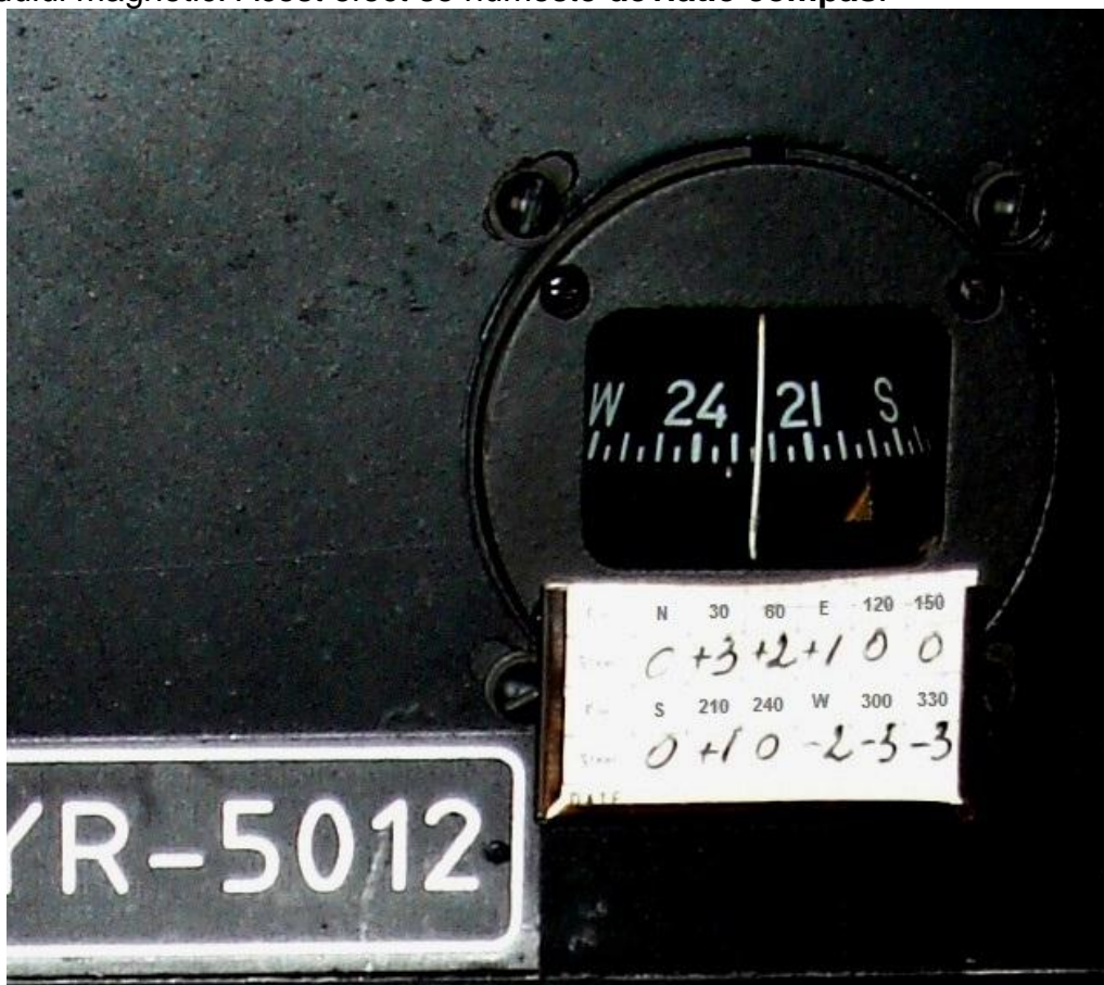
Fig. 4.26. Busola Aerostar Festival și cardul de compensare a busolei
