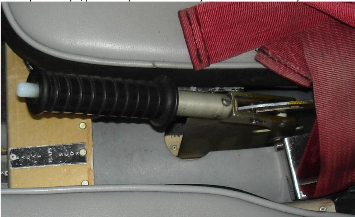
Fig. 1.23. Comanda din cabina a flapsului-Aerostar Festival
