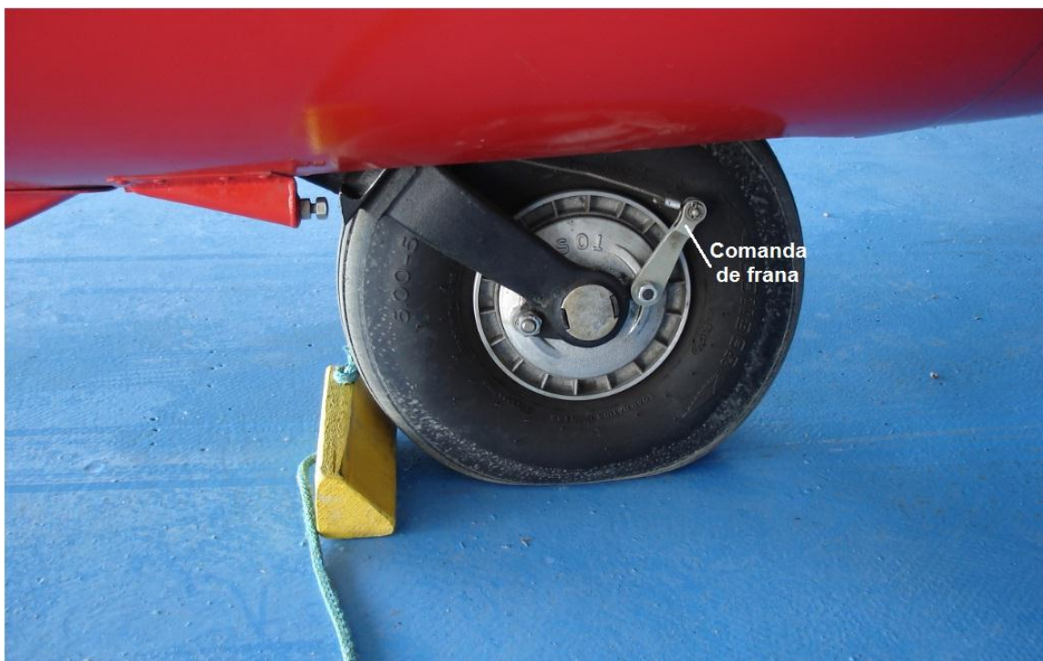
Fig. 1.34. Frana pe roata actionata prin cablu IS 28 B2. Actionarea franei pe roata la acest tip de planor se afla in continuarea franei aerodinamice
