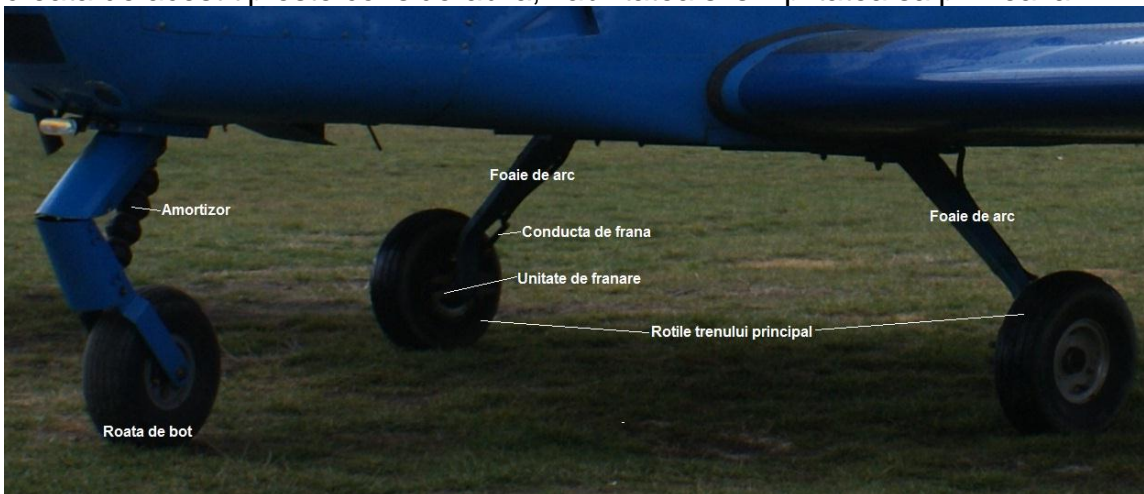
Fig 1.24 Tren de aterizare Aerostar Festival
