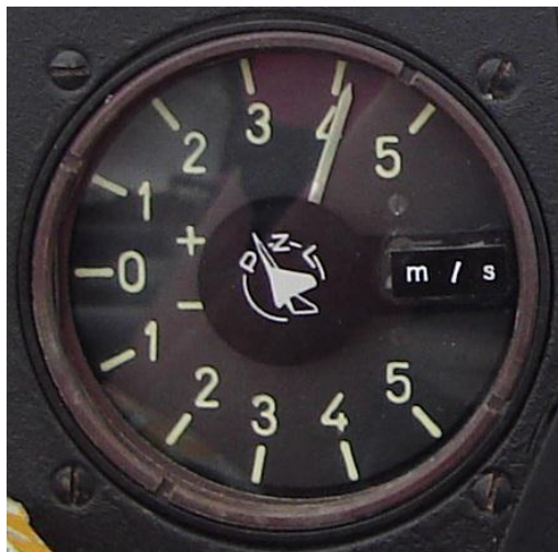
Fig 4.15. Variometru de energie totală (VET) IS 28 B2
