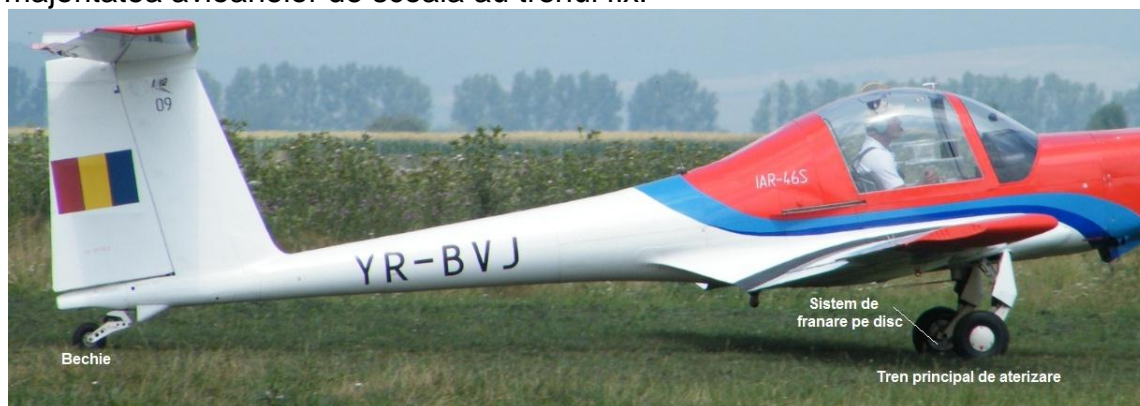
Fig. 1.25. Tren de aterizare IAR 46 S
