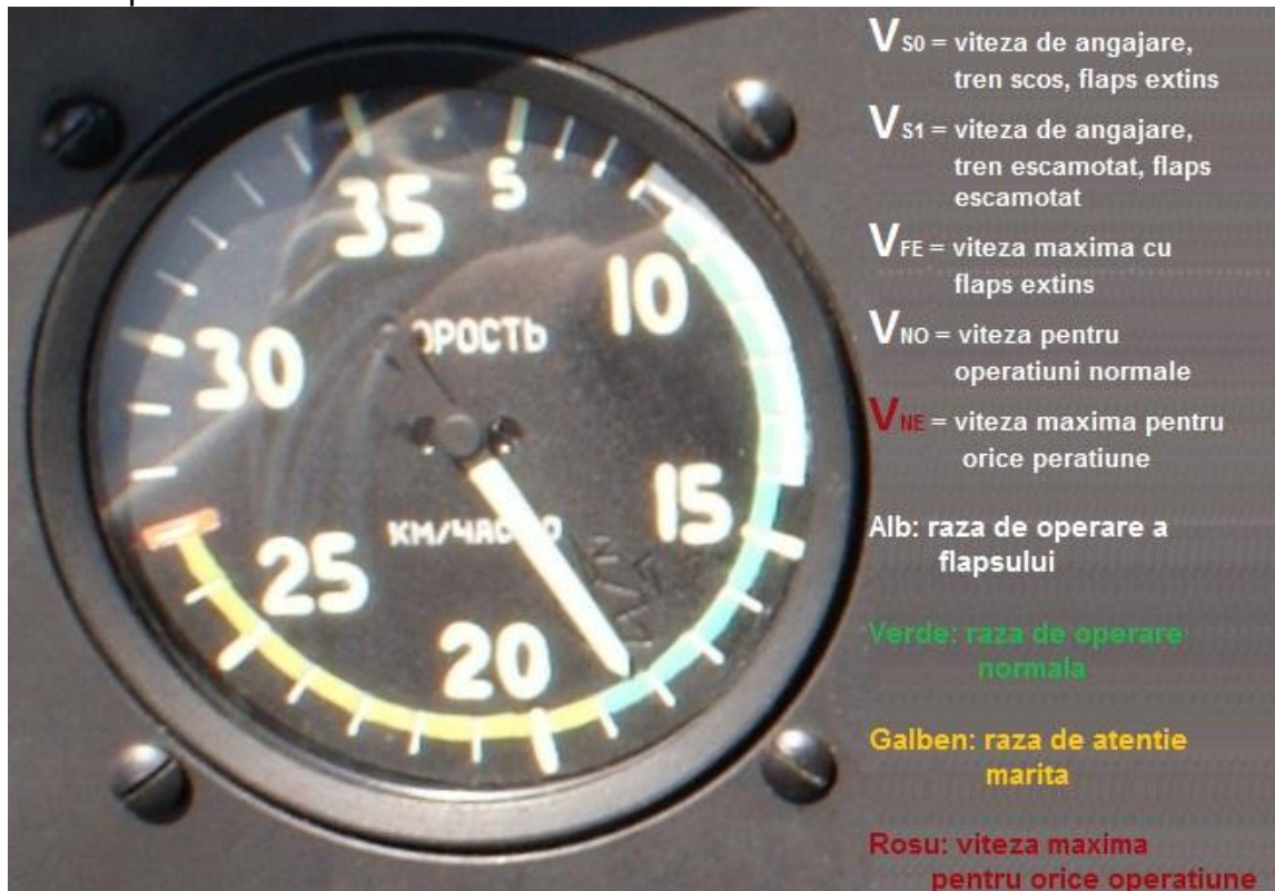
Fig. 4.8. Marcarea în culori a vitezometrului
