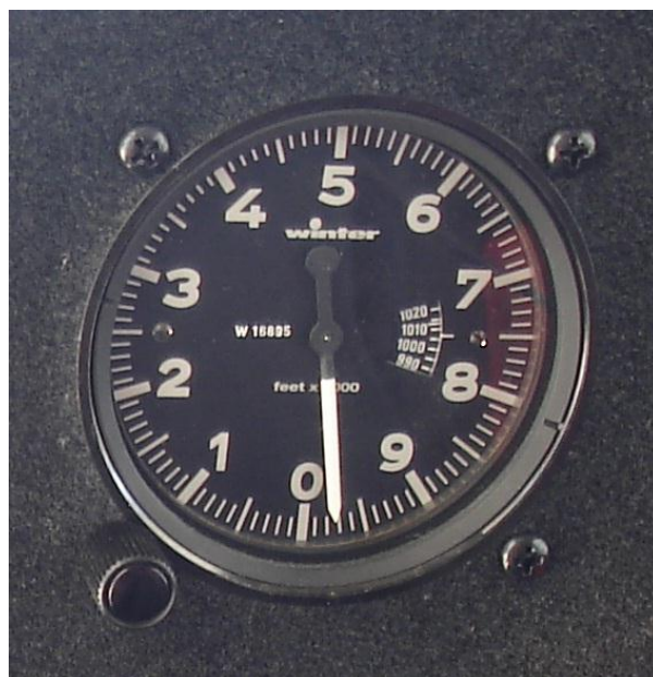
Fig. 4.10. Altimetru Ikarus C 42
