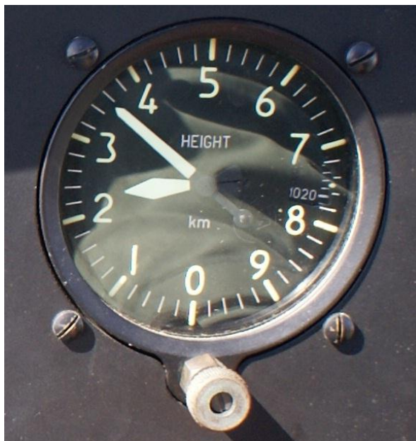
Fig. 4.9. Altimetru IAR 46 S, IS 28 B2
