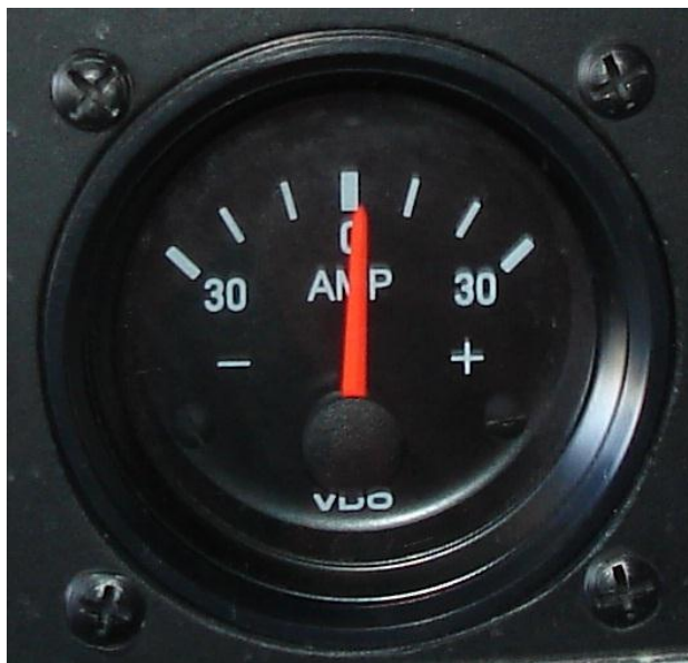
Fig. 3.4. Ampermetru Aerostar Festival
