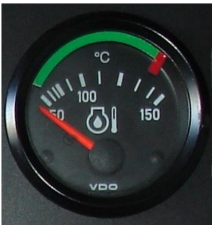
Fig. 2.15. Indicator de temperatura chiulasa Rotax 912
