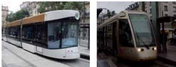
**Les tramways sur pneu** sont guidés par un rail unique. Ces systèmes sur pneu ont une conception assez proche de celle des tramways classiques sur fer et permettent de transporter le même nombre de voyageurs.
