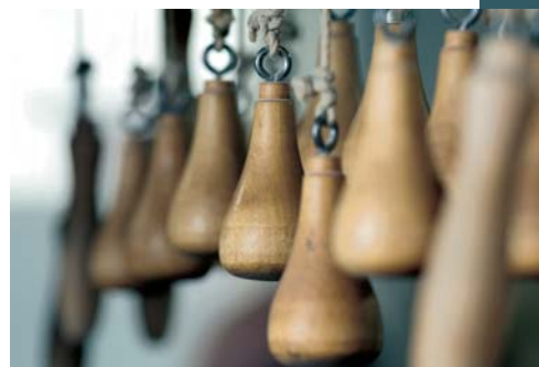
Reglage i svarvat trä för inställning av sikten i valskvarnen.
