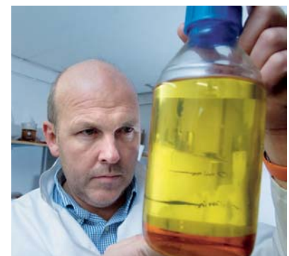
Sven Norup med ett prov på den kallpressade rapsolja som utgör råvara till produktionen av RME.
