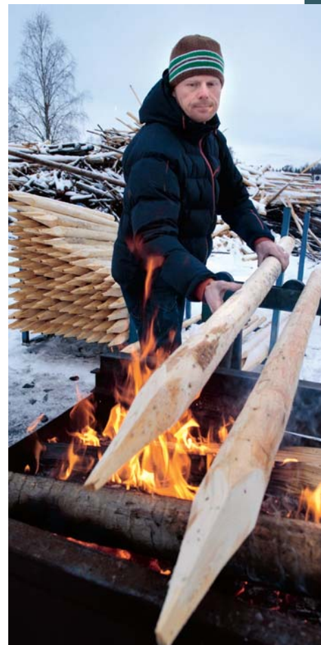
Genom bränning av den del av stängselstolparna som ska ner i marken ökar livslängden.
