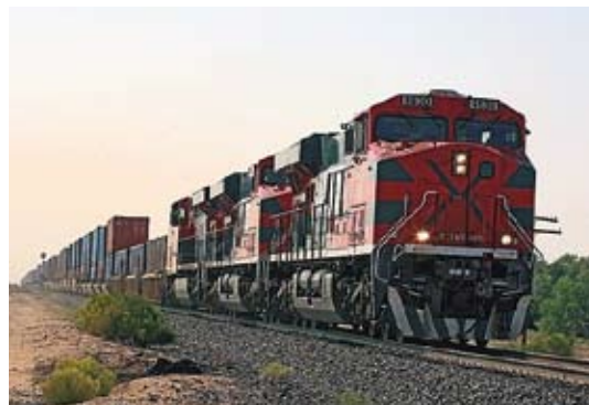
Tren de Ferromex con triple tracción y contenedores en double stack, México.
