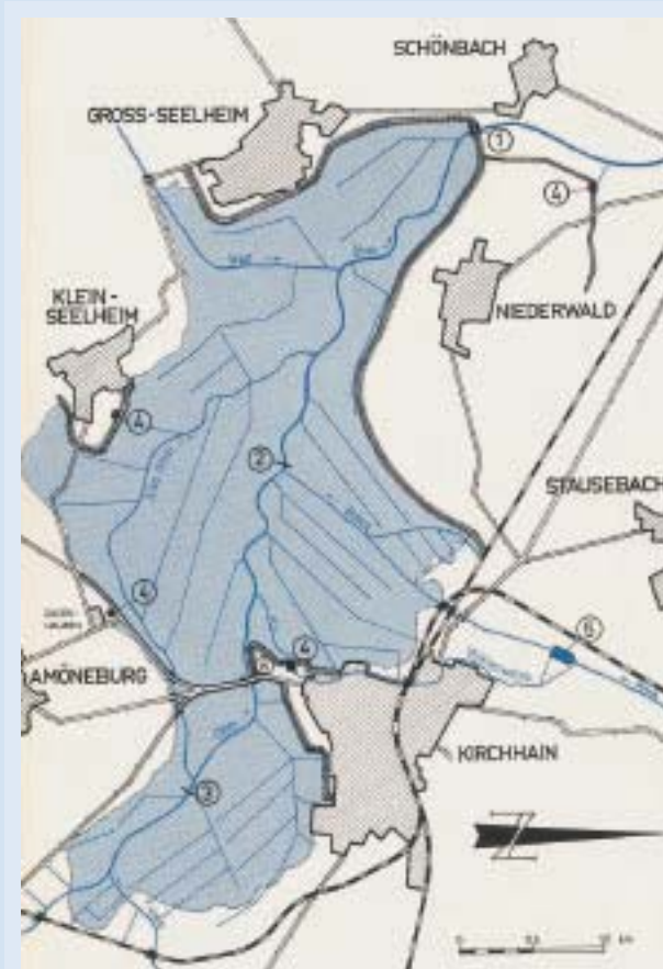
Abb. 18: HRB Kirchhain/Ohm – 2/3 Stauraum 17 Mio. m 3 Staufläche 900 ha
