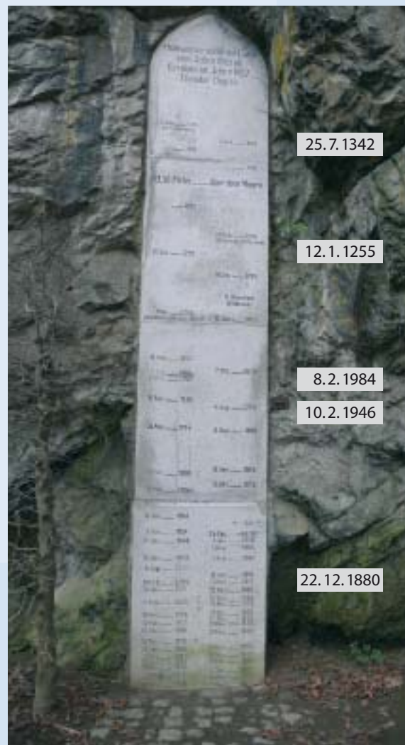
Abb. 3: Lahnwasserstände am Domfelsen in Limburg/Lahn. Der höchste Wasserstand der Lahn wurde am 25.7.1342 gemessen. Foto: Werner Gleim
