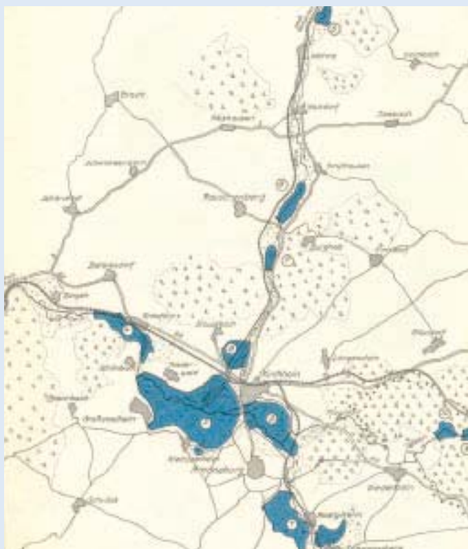
Abb. 15: Übersichtsplan der Planungen von Rückhaltemaßnahmen im Ohm-Wohra-Gebiet. Insgesamt war der Bau von zehn Rückhalteanlagen geplant, umgesetzt wurden die Maßnahmen 2, 3 und 5.
