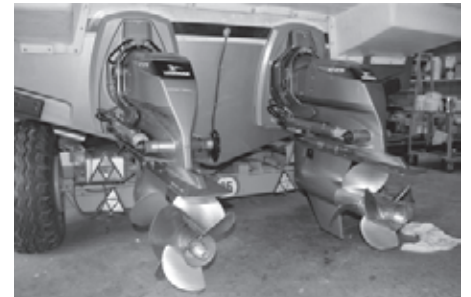
Die Antriebe des Rettungsbootes wurden ersetzt.
