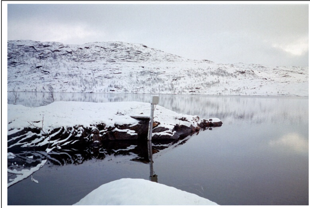
Figur 4.2.1: Målestasjonen i Røvatnet, 23. oktober 2001. Lokal vannstand er 0.97 m, dette tilsvarer kote 472.16. Se også figur 3.3.a. og 3.3.b.
