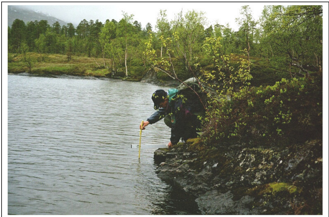
Figur 2.2.2 : Manuell måling av vannstand i Melkevatnet den 20. juni 2000 kl 0945. Vannstanden i kotehøyde måles til 94.105 moh. Se også figur 5.3.2 og tabell 2.2.
