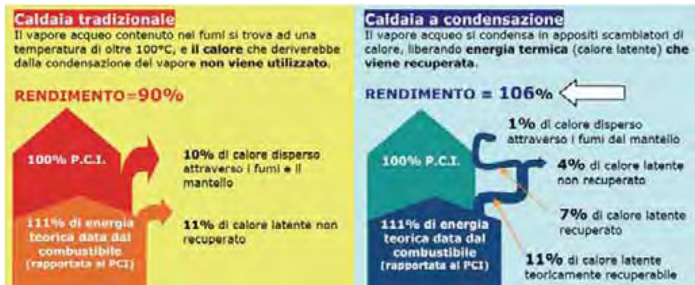
Figura 1 - Confronto caldaia tradizionale e caldaia a condensazione
