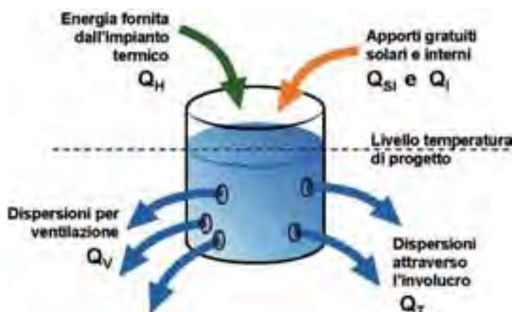
Figura 5: Analogia idraulica: interazione edificio - impianto
