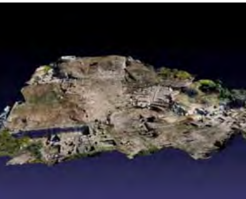
Figura 3: Nuvola di punti dell'intera area del teatro generata da fotogrammetria aerea
