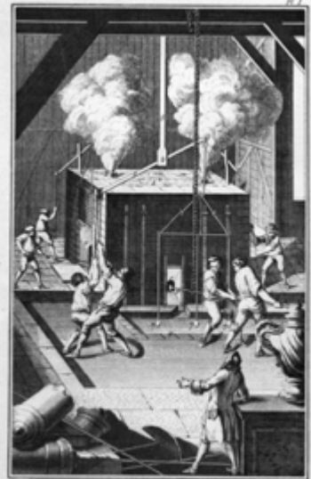
Sculpture, Fonte des Statues Équestres. Atelier de la Fonderie en l'épuration des Cores de la Figure en Bronze. FIG. 202. — Finances en moment de la cire.
