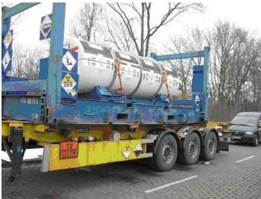
Abbildung 3-1: Durchgerostetes Transportgestell für Uranhexafluorid-Behälter
