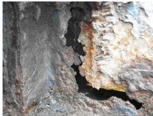
Abbildung 3-1: Durchgerostetes Transportgestell für Uranhexafluorid-Behälter
