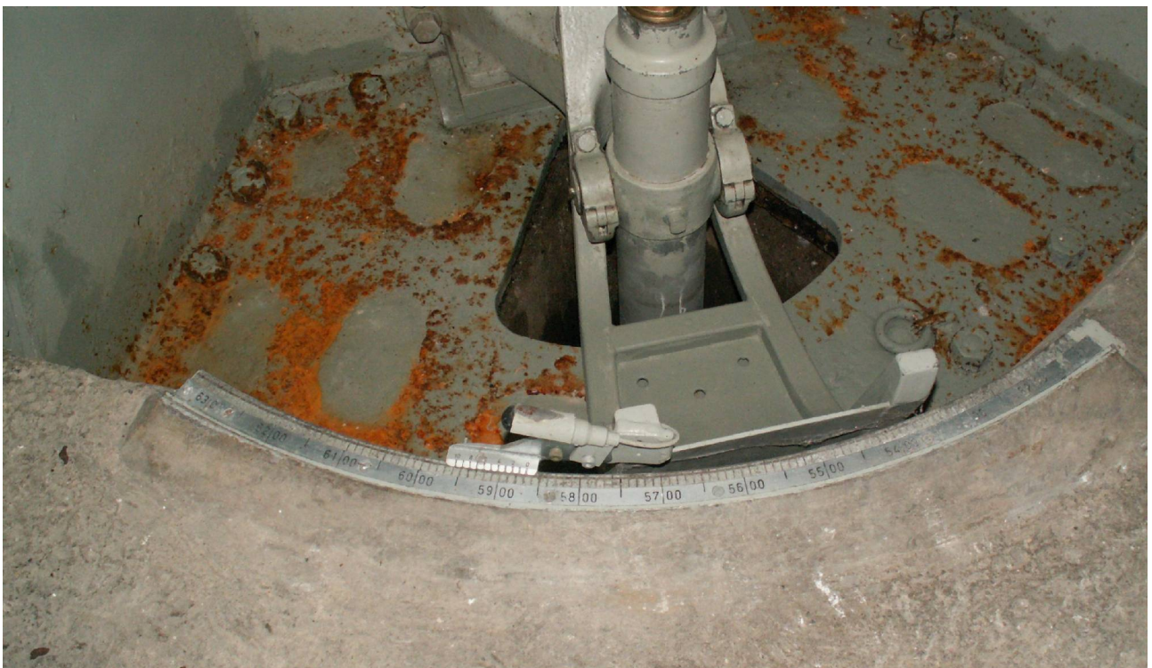
Abbildung 65: Richtkreis am Boden der Lafette
