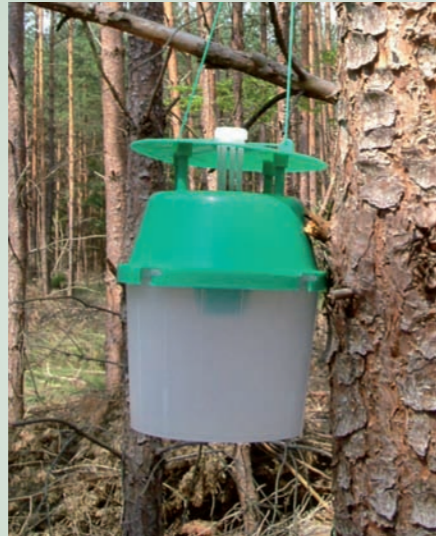
Die Pheromonfalle „Variotrap“ hat bislang nur unterstützenden Charakter bei der Prognose der Kiefernspannerdichte
