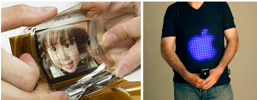
FIGURE 6 – Applications actuelles de la OLED : (a) Écran flexible pour nouveaux télévisions à haute définition (b) Tee-shirt éclairé
