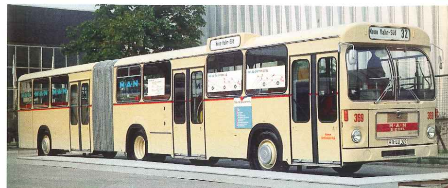
Für den MAN 890 SG von 1969 fertigte Göppel anfangs nur die Nachläuferaufbauten.
