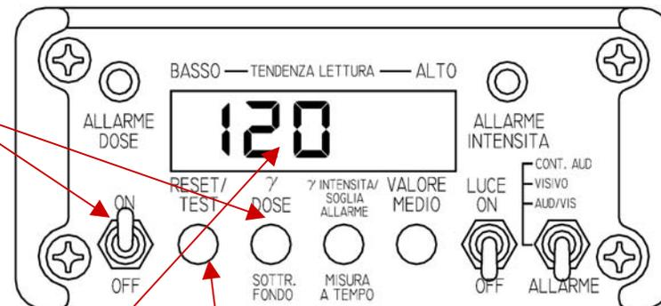
Premere il tasto RESET/TEST per tornare al funzionamento normale con la sottrazione del fondo inserita. Questa funzione rimane attiva fino a quando lo strumento viene spento.
