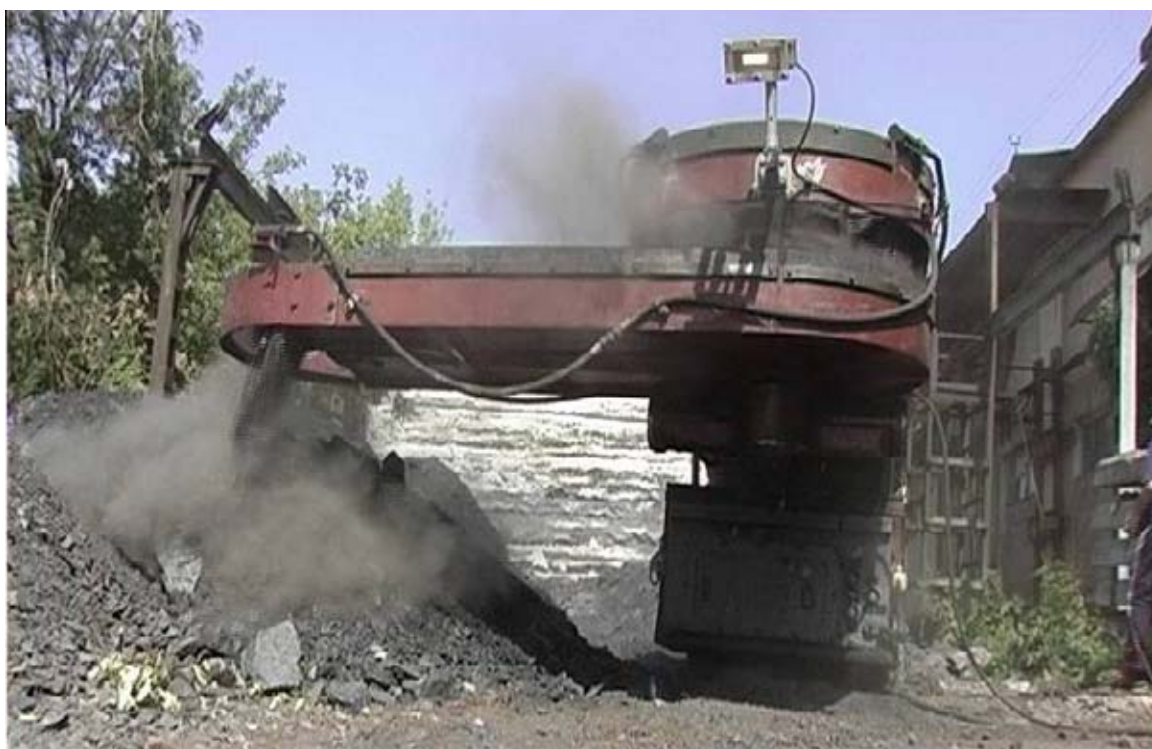
Рис. 5. Выгрузка горной массы с развернутым на 90^{\circ} скребковым перегружателем
