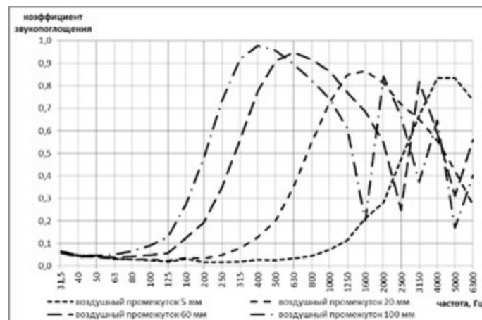
Рисунок 5. Частотная зависимость коэффициента звукопоглощения \alpha карбоновой звукопоглощающей конструкции с сеткой 1 мм
