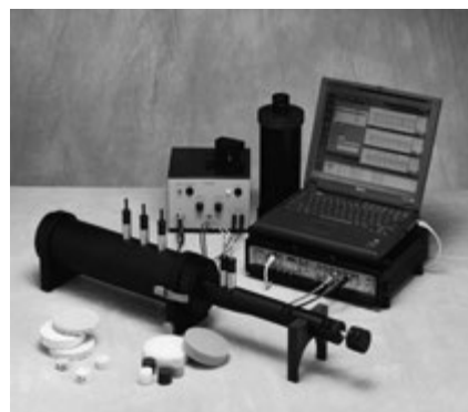
Рисунок 2. Многофункциональный анализатор типа 3560 С системы PULSE и импедансная труба типа 4206
