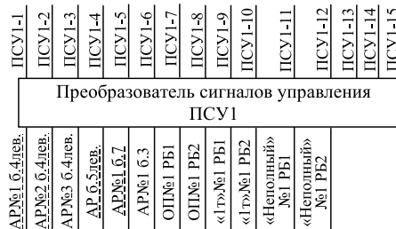
Рисунок 3. Структурная схема ПСУ1, разработанная для оценки показателей безотказности подсистемы управления расходом топлива
