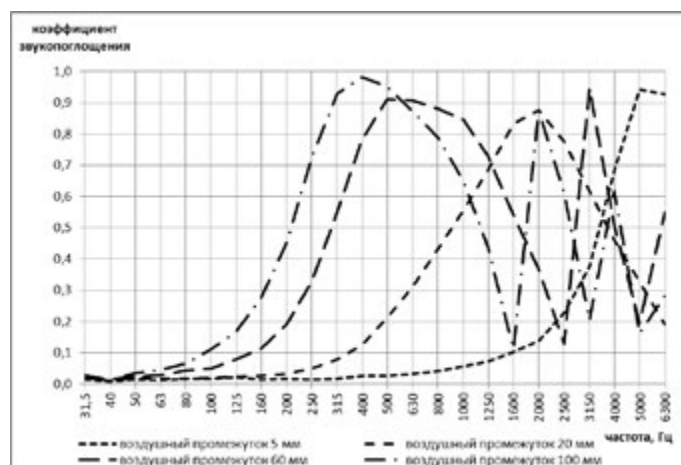
Рисунок 6. Частотная зависимость коэффициента звукопоглощения \alpha карбоновой звукопоглощающей конструкции с сеткой 2 мм
