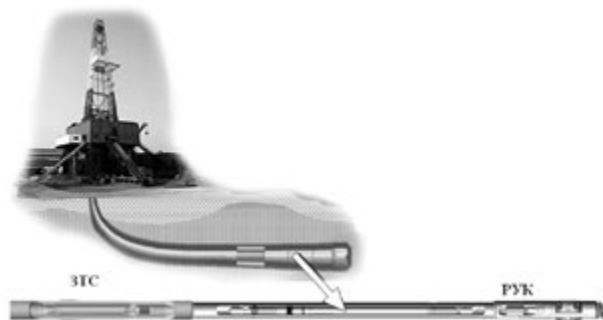
Рисунок 5. Основные технические средства автоматизированного комплекса управляемого роторного бурения
