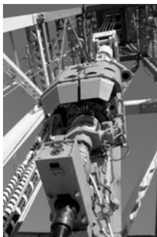
Рисунок 6. Серийный ВСП ПВЭГ-250 (разработчик и производитель – ОАО «Электромеханика»)
