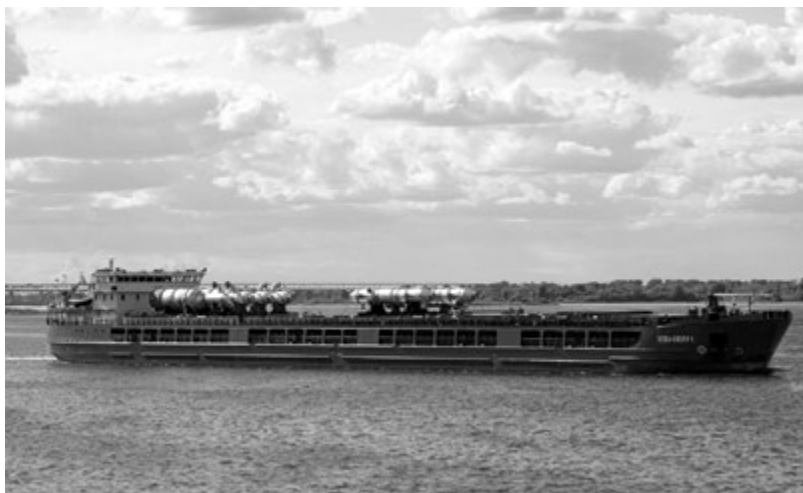
Рисунок 2. Сухогрузное судно смешанного плавания «Волго-Дон макс» класса «Нева-Лидер 1» проекта RSD49, построено Невским ССЗ в 2012 году. Фото: Евгений Бородин
