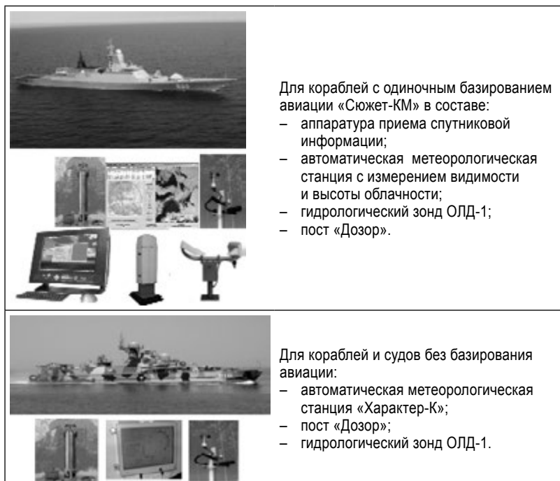
Рисунок 6. Корабельная автоматизированная информационно-измерительная система гидрометеорологического обеспечения безопасности полетов морской авиации в трех модификациях
