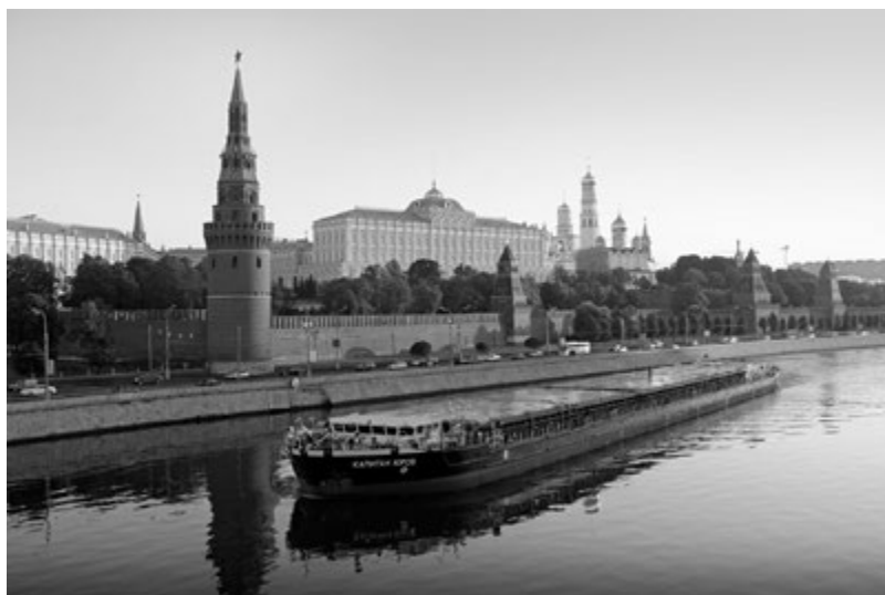
Рисунок 1. «Устьевое» сухогрузное судно «Волго-Дон макс» класса с пониженным надводным габаритом «Капитан Юров» проекта RSD44, построено Окской судостроительной верфью в 2011 году. Фото: Александр Конов
