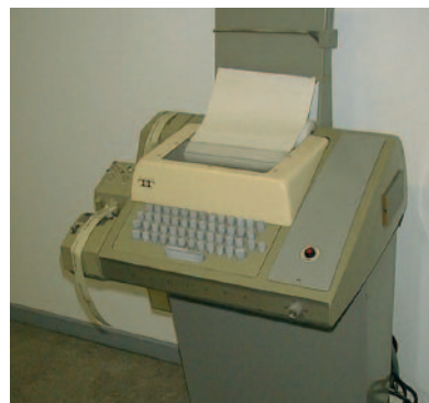
De teletype. Snelheid: tien tekens per seconde. / Foto: DHV.
