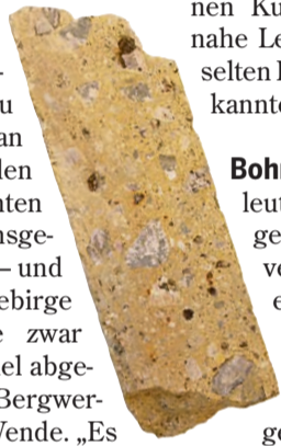
Was aussieht wie Beton, ist ein Bohrkern, der Seltene Erden enthält.
