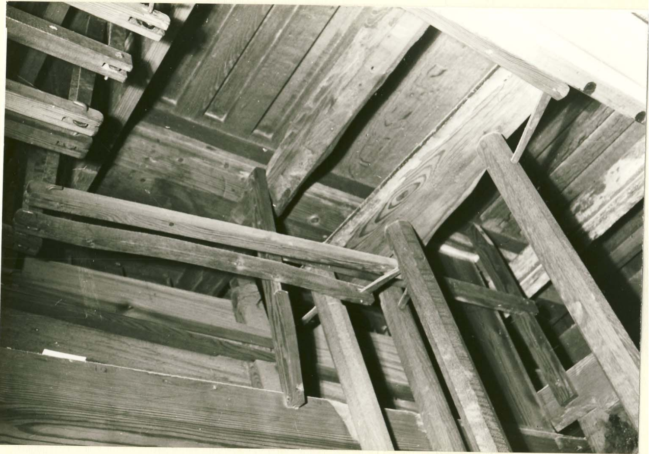
C Unterseite Kanzellen der Hauptwerkslade
