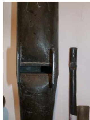
Typische, kurze und stark gewölbte Labienform, daneben 1/8'-Pfeife
