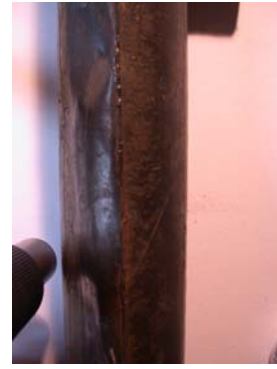
Typische Längsnaht und Metallstruktur
