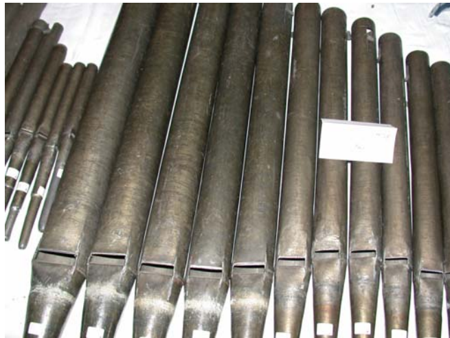
Typisch die querlaufende goldfarbene Metallstruktur der Kösterschen Pfeifen
