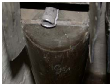
Charakteristisches, von außen gezirkeltes Unterlabium
