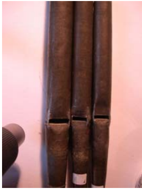
Kleine Innenpfeifen, die Labien nur markiert und kurz, rund gedrückt
