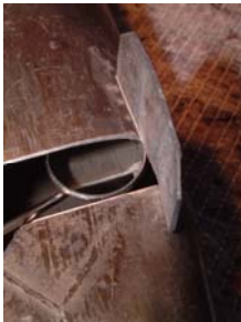
Labiumlinien an der Innenseite
