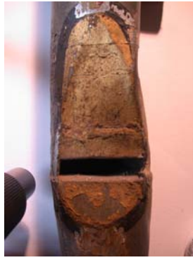
Köster bevorzugte für die Prospektpfeifen noch die gotischen Labien
