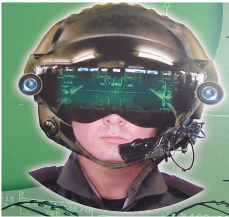
Resim 9: AVCI kaska monteli nişangah sistemi
