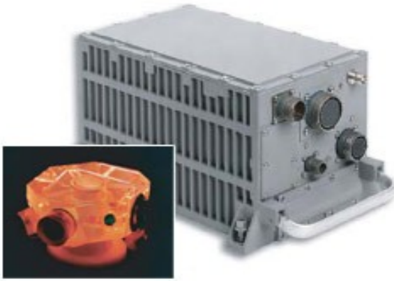
Resim 10: LN100G INS/GPS Seyrüsefer Cihazı
