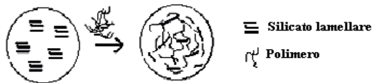
Figura 3.9 Sintesi di nanocompositi polimerici via Melt-Blending.
