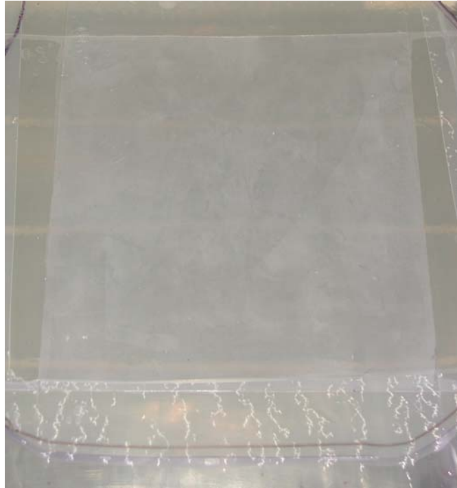
Figura 8.44 Superficie del campione a base EVA, idrotalcite al 2.5% ed additivo anticondensa sottoposta a costante condensa di acqua.
