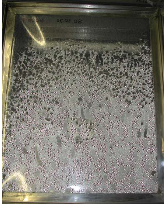
Figura 8.38 Superficie del campione a base EVA ed idrotalcite al 2.5%, sottoposta a costante condensa di acqua.
