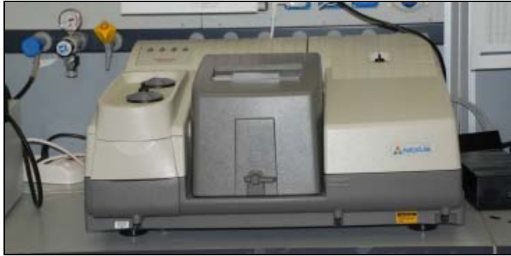
Figura 7.8 Spettrofotometro infrarosso in trasformata di Fourier Nicolet Nexus 670.
