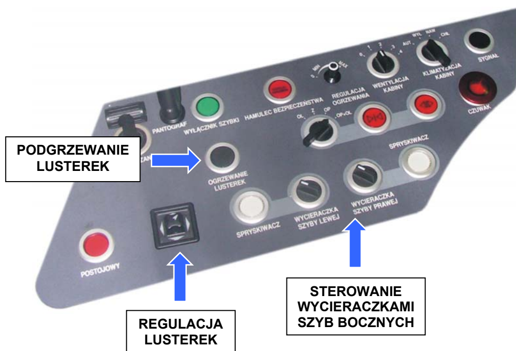
Rysunek 78. Panel sterownia lusterek wstecznych
