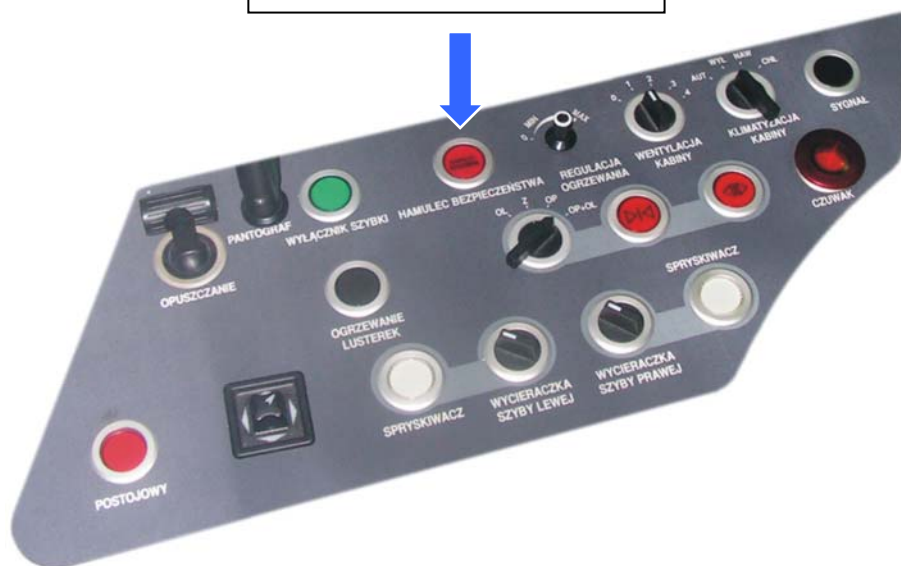
Rysunek 34. Pulpit maszynisty – przycisk mostkowania hamulca bezpieczeństwa
