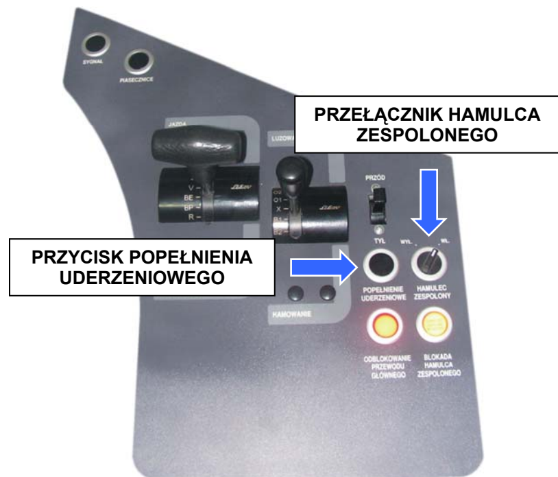
Rysunek 17. Widok pulpitu maszynisty - hamulec zasadniczy
