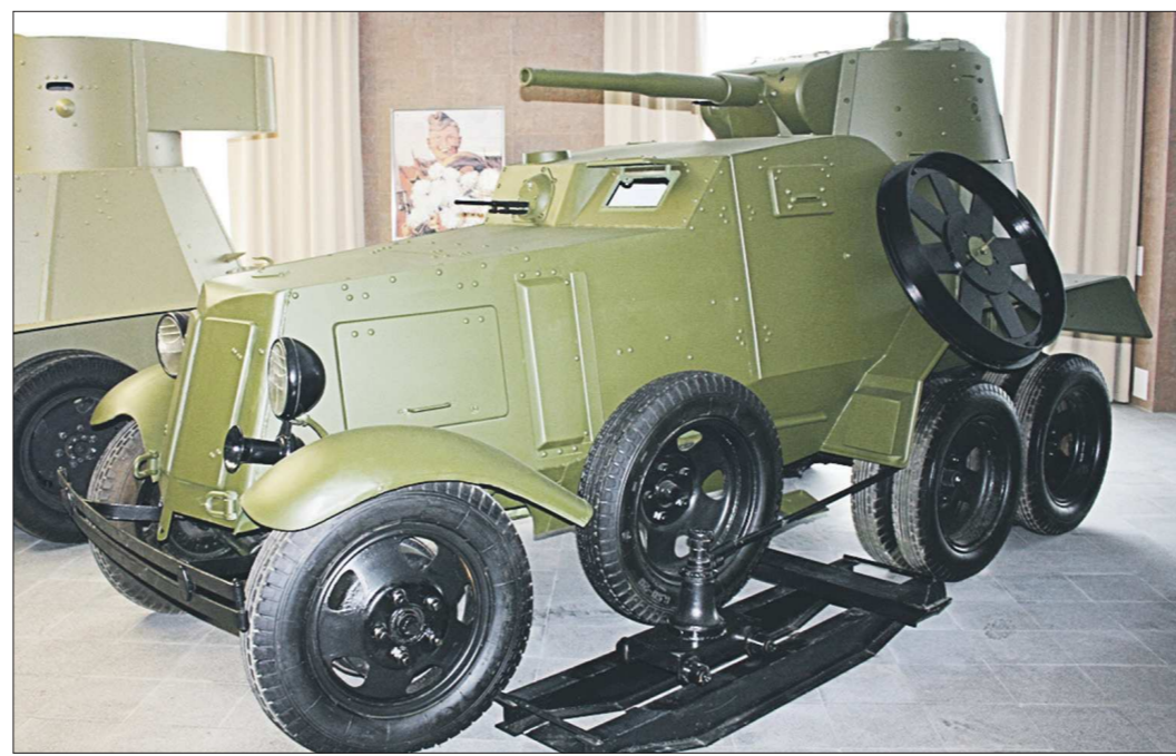
Уникальный броневик с помощью домкрата за час превращается в маленький бронепоезд. Или бронедрезину?
