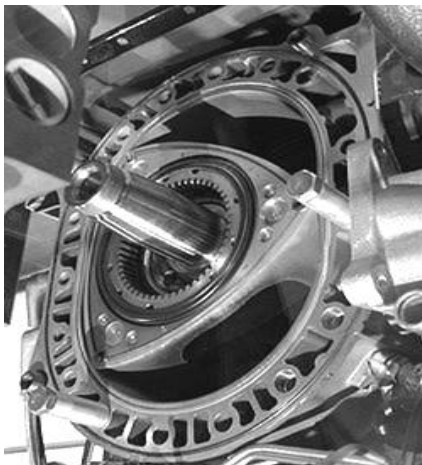
Рис. Общий вид роторно-поршневого двигателя
