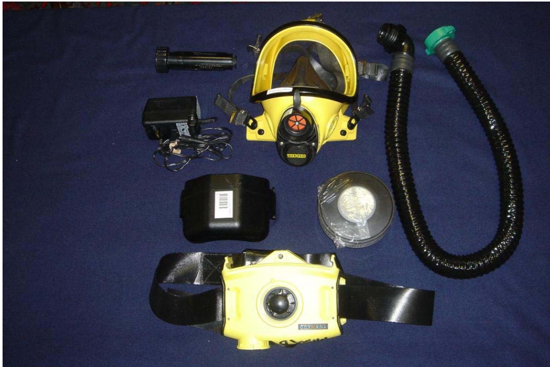
8.2. ábra Légzésvédő eszköz (A fénykép az UK HSE-től származik)
