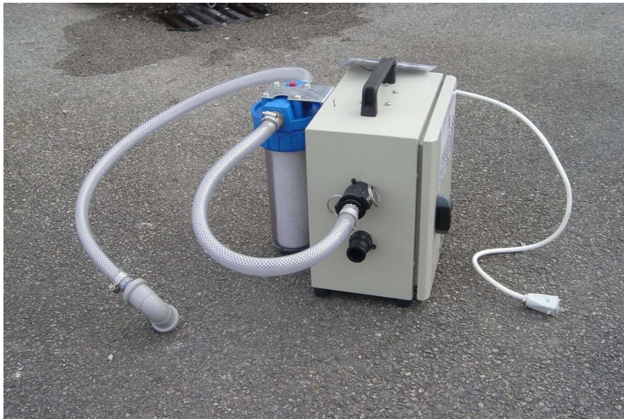
8.1. ábra A fertőtlenítőegység vízszűrő berendezése. (A fénykép az UK HSE-től származik)
