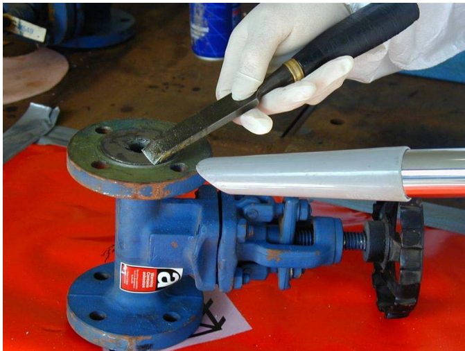
11.6. ábra Folyamatos porszívózás az előző művelet során keletkezett por eltávolítása céljából.
