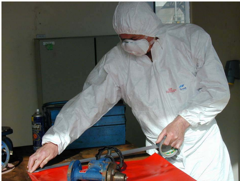
11.3. ábra Szalag és polietilén fólia használata, mielőtt egy szelepet megtisztítanak az azbeszttömítéstől, a munkafelület védelme céljából
