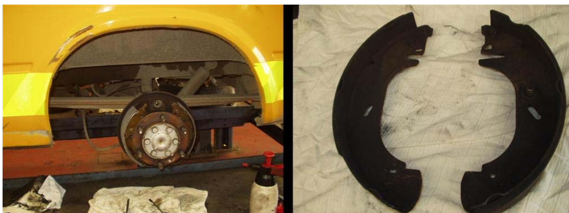
18.1. ábra Teherkocsi fékpofájában található azbeszt
